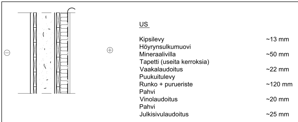
Kuva 37. Rakennus C, Ulkoseinän periaateleikkaus RA2 kohdalta.
