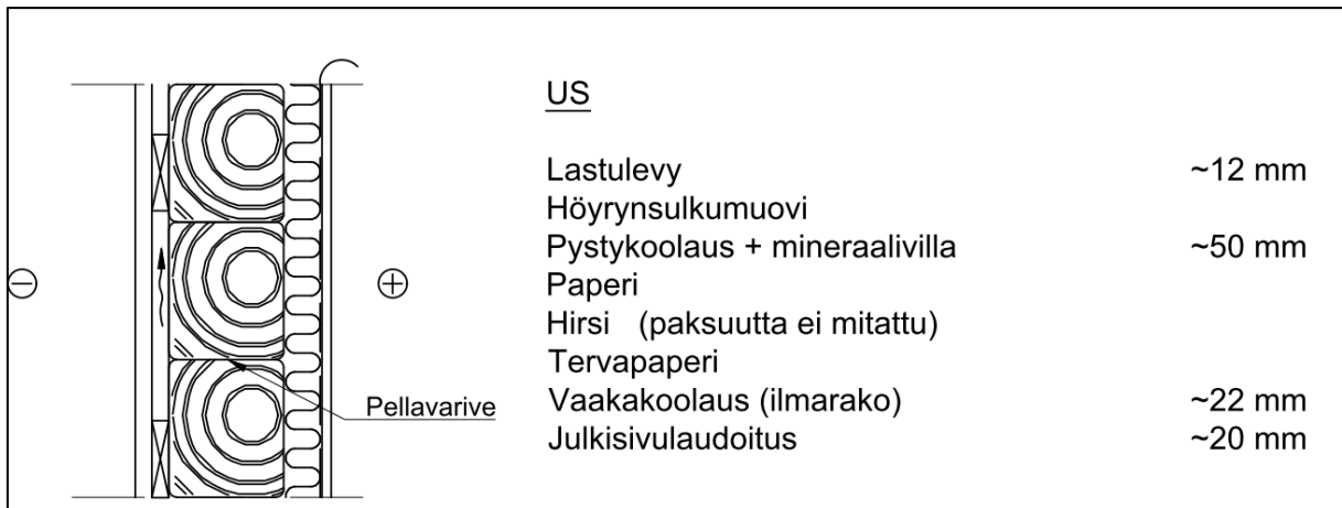
Kuva 17. Ulkoseinän periaateleikkaus liikuntasalin kohdalta, RA5.
